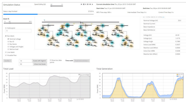
Abbildung 2: Simulation der Netztopologie in DPG.sim auf Basis der importierten Messdaten
